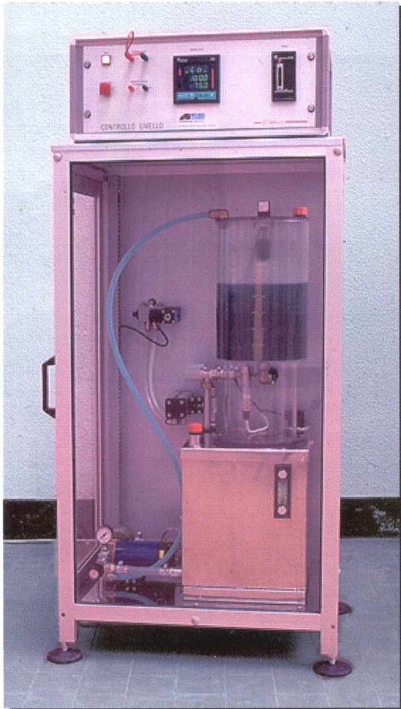
In foto, modulo didattico di controllo livello
